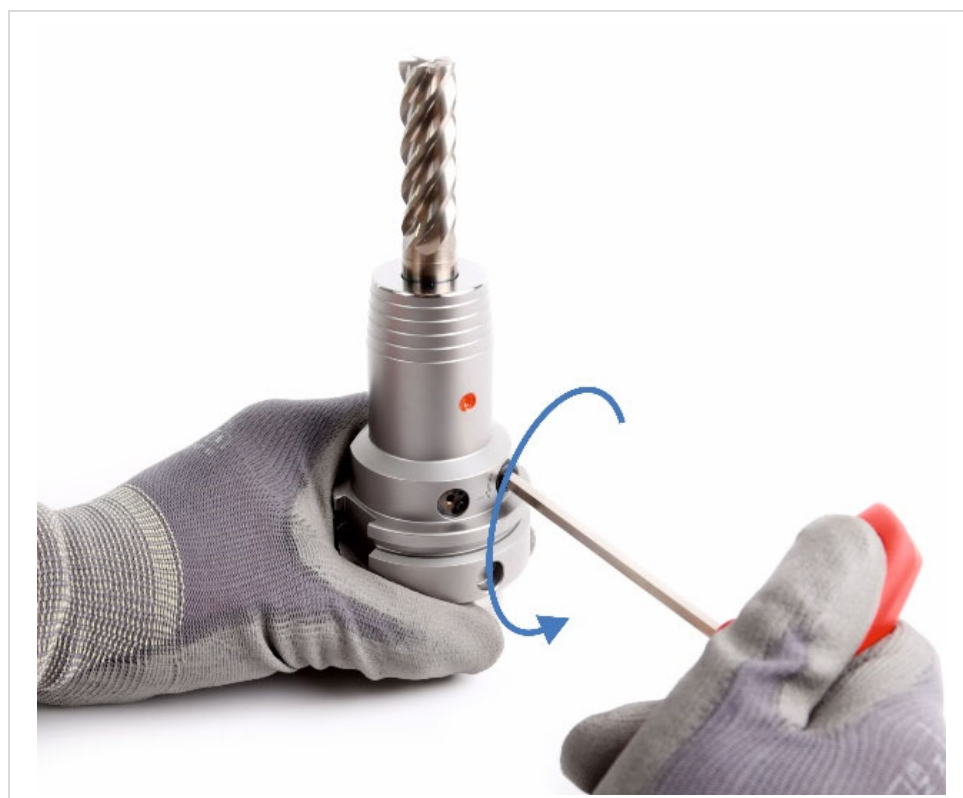
図 13: 締め付けねじをゆるめる
