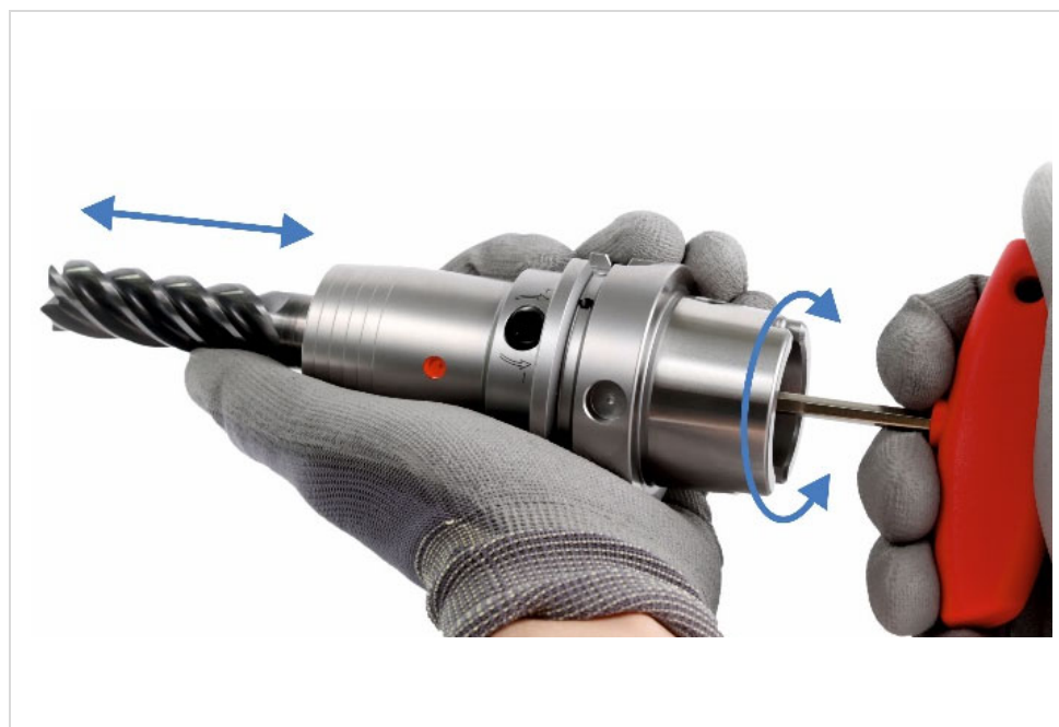
図 9: 工具長の調整 (軸心アクセス)
