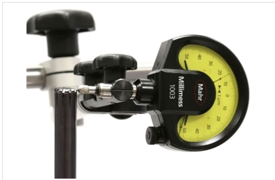
図 16: 外周振れの測定
